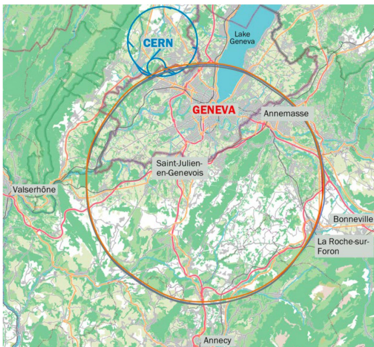
Abbildung 1: Varianten für den FCC. Der FCC reicht vom Jura bis fast nach Annecy (F) und führt unter dem Genfersee hindurch. © CERN
