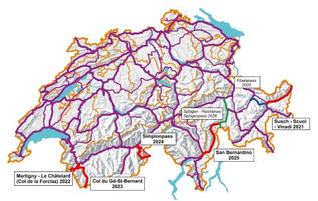
Abbildung 2: Landeshöhennetz und geplante Neumessungen 2021–2025 (rote Linien)
