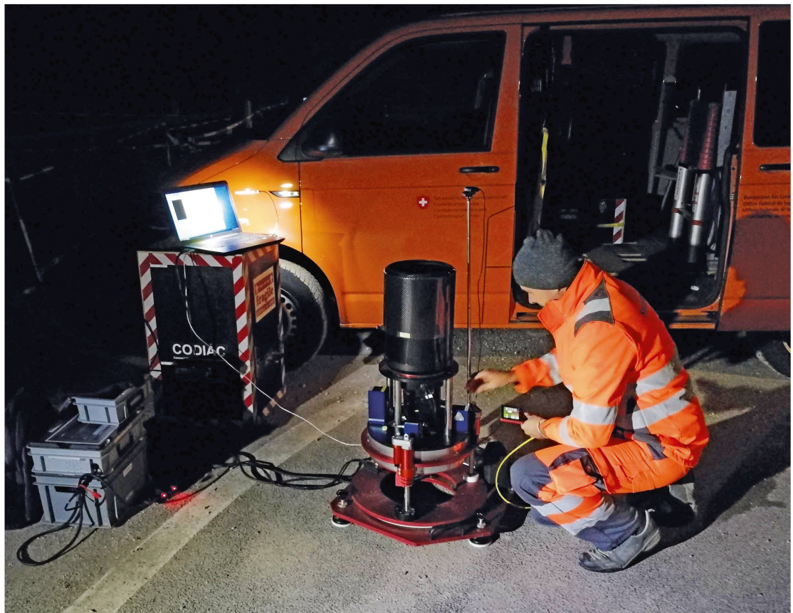
Abb.: Lotabweichungsmessung mit der digitalen Zenitkamera CODIAC
