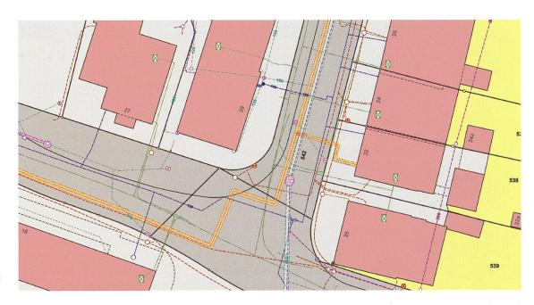
Abbildung 2: Beispiel für die Darstellung aus einem Leitungskataster
