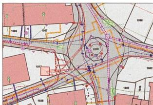
Wird in Zukunft die Nutzung des Untergrundes standardisiert dokumentiert? Beispiel für die Darstellung aus einem Leitungskataster: die verschiedenen Farben stehen für unterschiedliche Werkleitungen für Wasser, Abwasser, Energie und Kommunikation.
