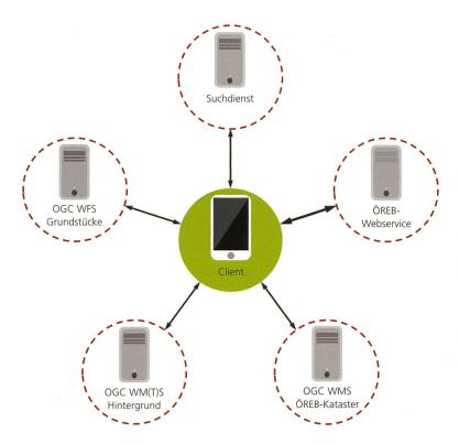
Abbildung 3: Schema der Systemarchitektur des Smart-Auszugs
