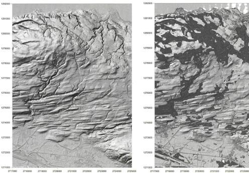
Abbildung 5: Beispiel Reliefschattierung DOM, Punkwolken und Querprofile anhand der LiDAR-Daten aus der RE 2017/2018
