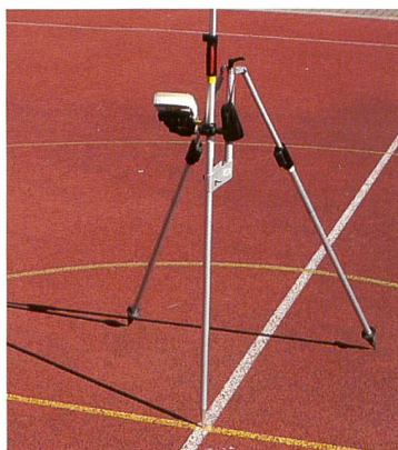
Abb. 2: Ob rot, ob grün, ob blau: Hochpräzise landesweite Passpunktmessungen (nicht nur auf Sportanlagen) bilden den geometrischen Anker orientierter Satelliten- und Luftbildprodukte von swisstopo.
