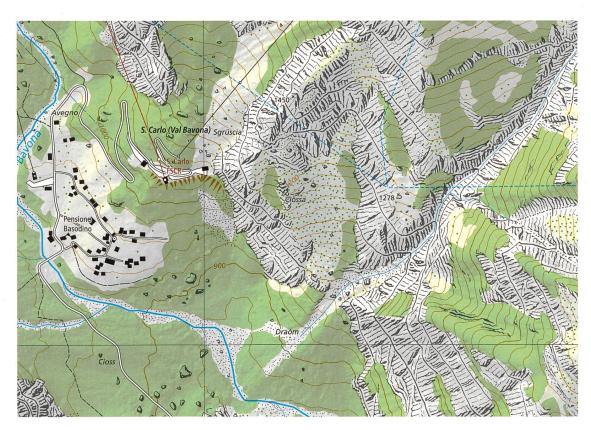
plastische Wirkung verstärkt werden. Die Felszeichnung der Landeskarte 1:25000 wird als aufgerasterte und pixelreduzierte Darstellung für den Massstab 1:10000 übernommen. Die Aktualisierung erfolgt parallel zur Nachführung der Landeskarte 1:25000. Somit können diese heute noch manuellen Arbeiten für mehrere Massstäbe genutzt und Synergien geschaffen werden.
