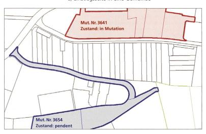
Abb. 4: Einstiegsansicht AV-Daten einer Gemeinde (rot = in Mutation bzw. in Bearbeitung durch ein Geometerbüro, blau = pendent bzw. beim Grundbuchamt zur Erledigung)
