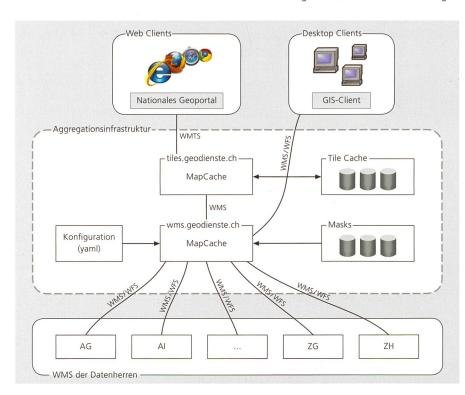
Abbildung 2: System-komponenten: Das System Vereinen harmonisierter Geodienste umfasst die Hauptkomponenten Clients, die Aggregationsinfrastruktur und die Geodienste der Datenherren (Kantone und Gemeinden sowie auch das Fürstentum Liechtenstein)
