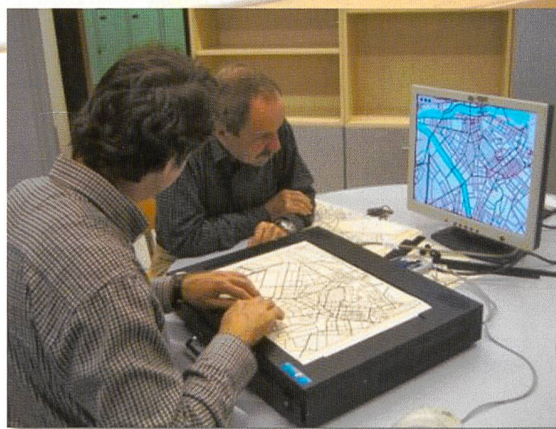
Abb. oben: Test des Plans der Arrondissements von Paris; zu jedem Arrondissement wird eine hörbare Information erteilt.
