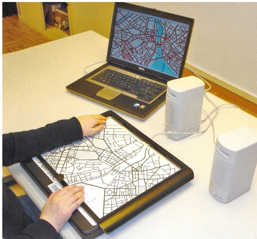
Abb. 1 oben: Bestandteile der Vorrichtung ABAPlans: ein Rechner, ein Tastfeld, ein Reliefplan und Lautsprecher
