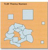
Abbildung 3: Die Daten aus SwissNames25 werden bei der Migration mittels FME mit den Daten der Flurnamen der AV kombiniert. Wenn AV-Daten vorliegen, werden die SwissNames-Daten automatisch ignoriert. Falls die AV-Daten fehlen, werden die SwissNames-Daten in Form von Polygonen (Grösse je nach Namenstyp) in die TLM-Datenbank migriert. Dann ist eine operative Bearbeitung im TLM erforderlich.
