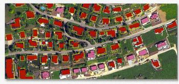
Abbildung 4: Gebäude aus der AV (rot) als Hilfe bei der Erfassung der 3D-Dachflächen des TLM (rosa); die Gebäude aus VECTOR25 sind als gelbe Kontur dargestellt.
