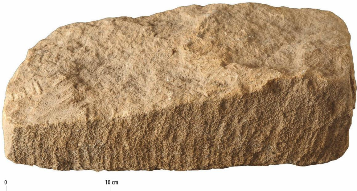
189 Keilstein Arch. 110 mit deutlichen Spitzspuren an der Vorderseite.
