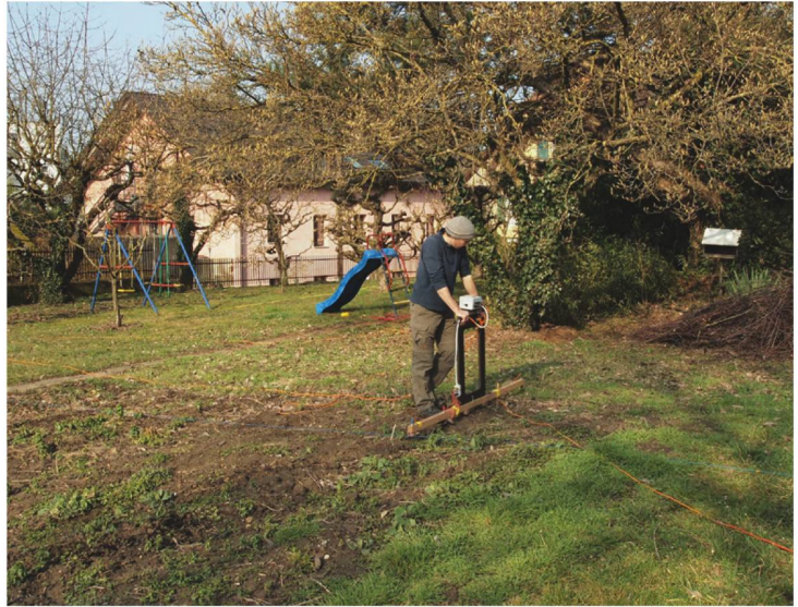
3 Geoelektrische Prospektion im Bereich des Westtores (Prospektion 2016.04).
