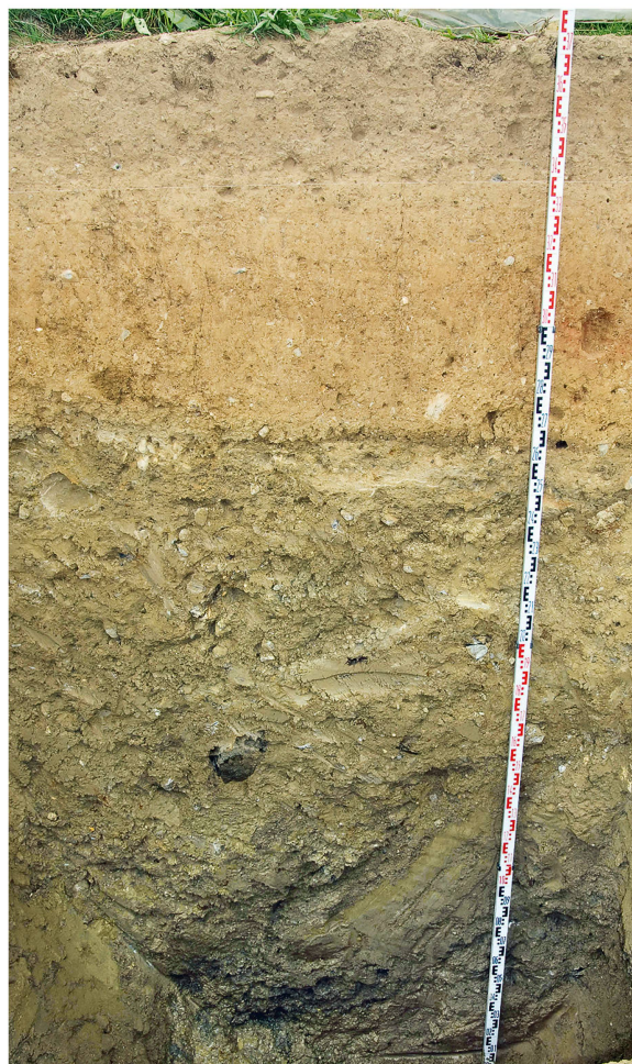
Fig. 170. Vue de la coupe PRF 3, dans la cuvette de la zone C. Sous les dépôts glaciaires, la roche calcaire n'a été atteinte qu'à une profondeur de 3.9 m. Dans la partie supérieure, un Luvisol s'est développé.
