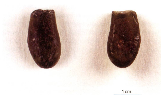
Fig. 105 – Sion, « Sous-le-Scex est ». Déchet de production. Coulure de verre en forme de goutte (cat. 236) ; verre vert foncé (vert olive). La surface en contact avec le plan de travail est plate et granuleuse (à droite).
