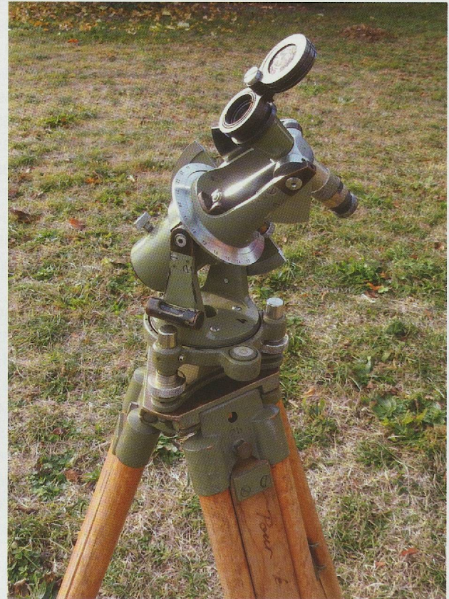
Fig. 183. Le sextant terrestre utilisé pour déterminer les parcours solaires.
