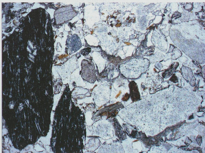
Fig. 139 — Vue sous microscope des sables tardiglaciaires. On distingue les encroûtements carbonatés développés sur la face inférieure des grains minéraux. À gauche, des gravillons redressés suite au gel-dégel (échantillon GM45, lumière analysée, largeur: 3.4 mm).
