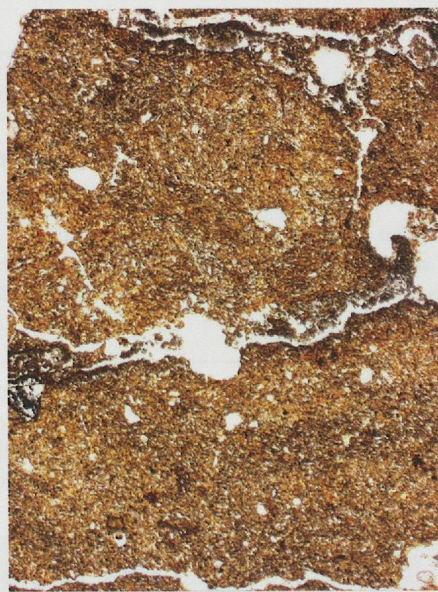
Fig. 138 — Vue sous microscope des silts glaciolacustres soumis à du gel-dégel (microstructure lamellaire, réseau de fissures parallèles). (Echantillon GM45, lumière analysée, largeur: 3.4mm).
