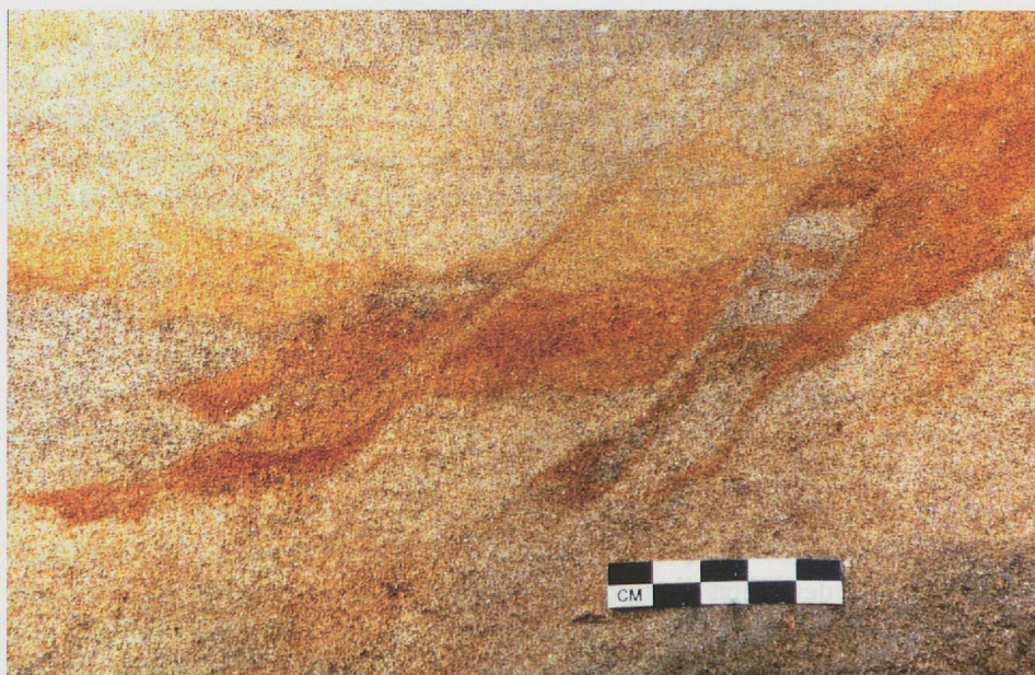
Fig. 49 — Détail de microfailles dans des sédiments sableux. Vue en section verticale. Echelle centimétrique.
