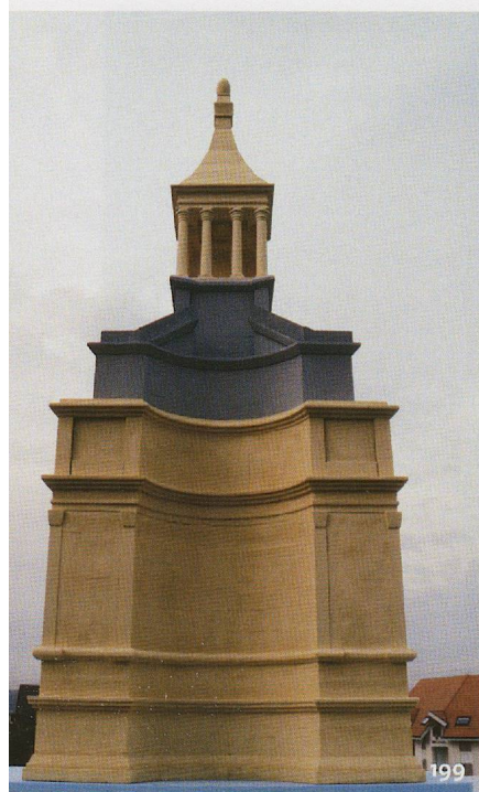
Fig. 199. La maquette au 1:10 en polystyrène. La maquette a servi à visualiser le tracé et le pendage des frontons courbes (à ce stade de l'étude, ce sont encore des demi-frontons en façade), et à vérifier les perspectives en contre-plongée.
