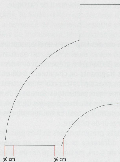
Fig. 207. En projection frontale, les pilastres engagée des angles externes et ceux des angles internes sont de même largeur.
