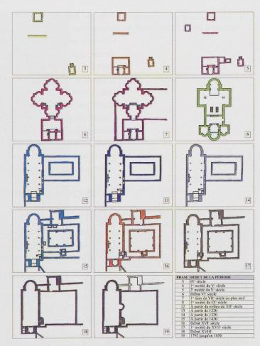
Fig. 2 — Évolution des phases architecturales du IV<sup>e</sup> au XIX<sup>e</sup> siècle (Renée Colardelle).
