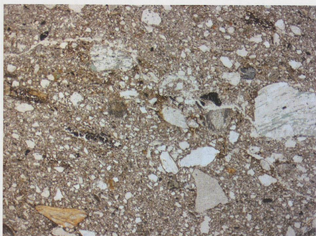
Silts contenant des fragments charbonneux (UT 20/18.5). La faible porosité, la disposition des éléments et la fissuration parallèle indiquent que ce matériel a été compacté (probablement chape). Lame M5.1, lumière analysée; largeur de la photo: 7,11 mm.
