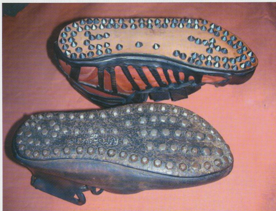
Fig. 388 : Comparaison entre un semelage usé et neuf.
