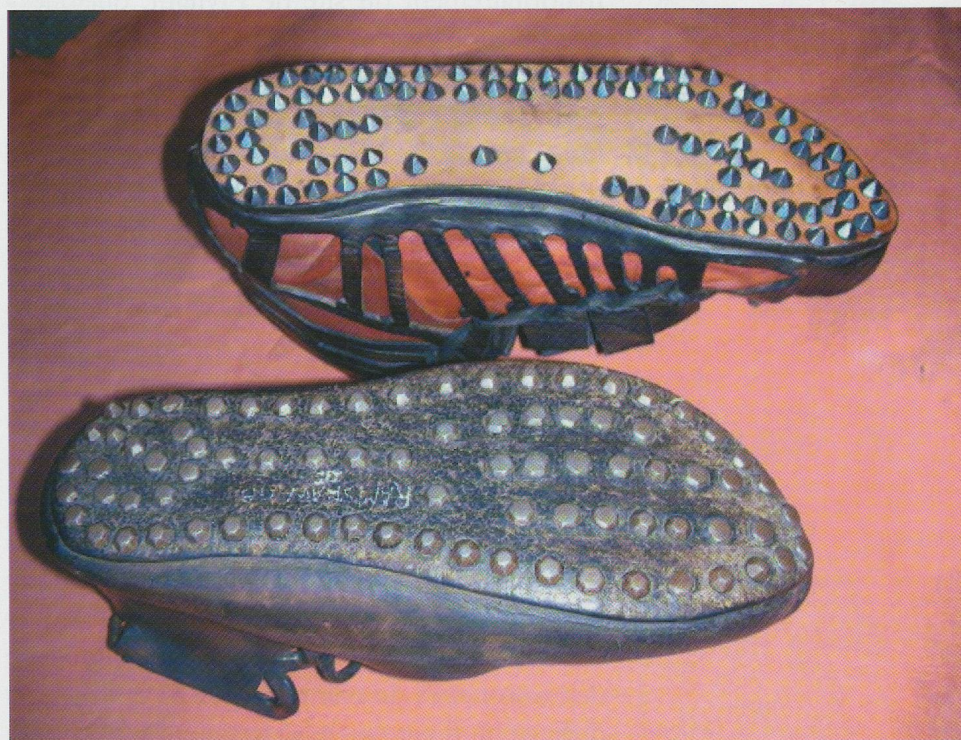
Fig. 388 : Comparaison entre un semelage usé et neuf.
