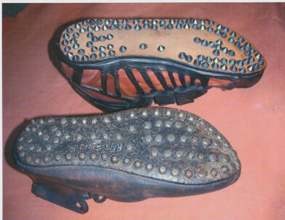
Fig. 388 : Comparaison entre un semelage usé et neuf.
