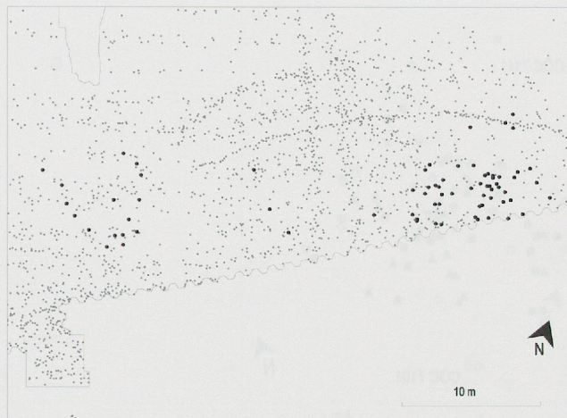
Fig. 98. Plan partiel du site, les points noirs correspondent aux pieux profonds et les points gris aux autres pilotis de la zone (éch. 1 : 500).
