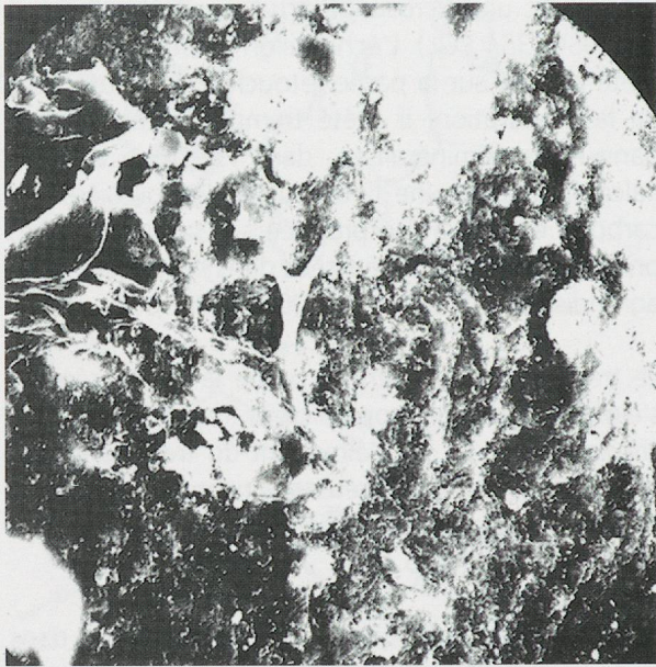
Fig. 7. Eléments attachés à la surface de l'outil. Agrandissement x 780 (photo J.Kaminska-Szymczak).
