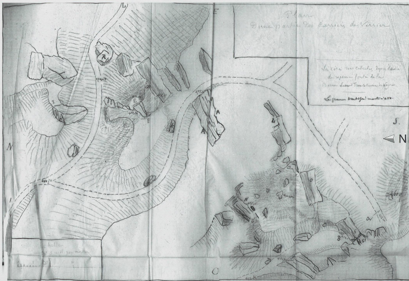
Fig. 31. Plan manuscrit sur calque d'A. Rochat, à l'origine du plan de la figure 33. Légende: « Les cotes sont calculées d'après celles du repère en fonte de la borne France-Suisse de Veyrier. Le gravier stratifié monte à 450. »
