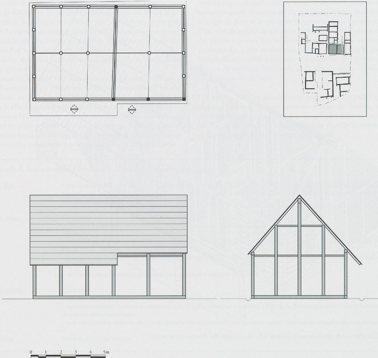
Fig. 219. Parcelle B, bâtiment avant (locaux 1 et 12) (état 4b). Type : à deux pièces. Plan et élévations schématiques. Pour les conventions graphiques, se reporter à la fig. 217.
