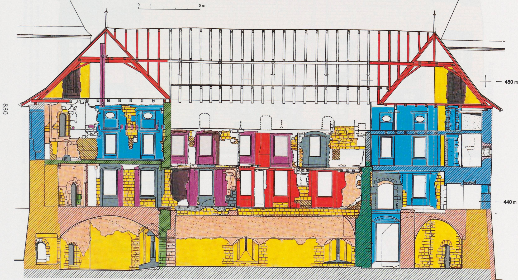
Plan 8. Château d'Yverdon, coupe est-ouest, vue vers le nord sur l'élévation intérieure de la courtine nord. Etat en 1994, avant la réhabilitation de l'aile nord. (Relevés: AAM, Jachen Sarott, Heinz Kellenberger; mise au net: Franz Wadsack)
