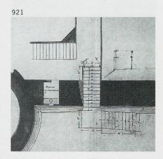
921. Château d'Yverdon, extrémité sud de l'aile ouest, projet d'entrée pour le collège-école moyenne, juillet 1871, de Jules Landry, échelle de l'original: 1:50 (détail). L'escalier a réutilisé l'embrasure de la fenêtre en 1778, il débouche dans le vestibule [120-1]. Contre [116], l'escalier qui permet de se rendre au deuxième étage. Dans l'épaisseur de la courtine, les latrines des instituteurs, situées sur le conduit de celles du Moyen Âge. (AY, Cartable n° 4 «écoles», n° 29, Fibbi-Aeppli)
