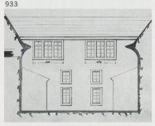
**932.** Château d'Yverdon, aile nord, coupe, «Château d'Yverdon, installation de nouvelles salles d'école, 2° projet», Francis Landry, février 1883, échelle de l'original: 1:100, détail montrant les modifications apportées à la charpente et le système de suspension des cloisons. (AY, cartable n° 4 «écoles», n° 31, Fibbi-Aeppli)
