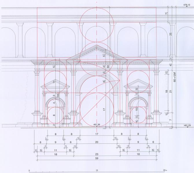
24. Façade du portail du Refour, avec ses schémas géométriques et ses axes en pointillés. Ech. 1:100.
