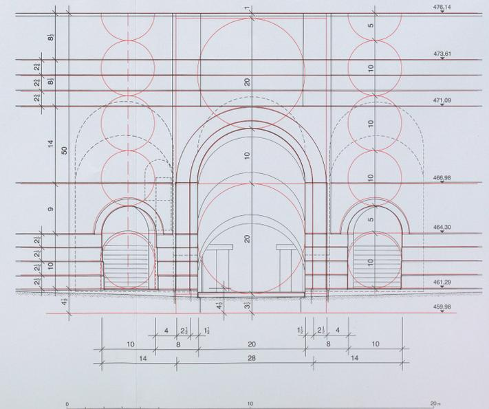
14. Etat 1. Façade est restituée, détail avec cotes et schéma régulateur. Ech. 1/100.
