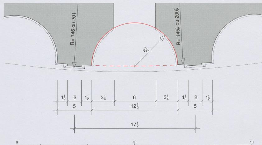
37.1. et 37.2. Etat 2. Plan et élévation d'une travée du mur périmétral à niches, avec insertion des fragments de maçonnerie récupérés en 1971 et schéma régulateur. Ech. 1:50.
