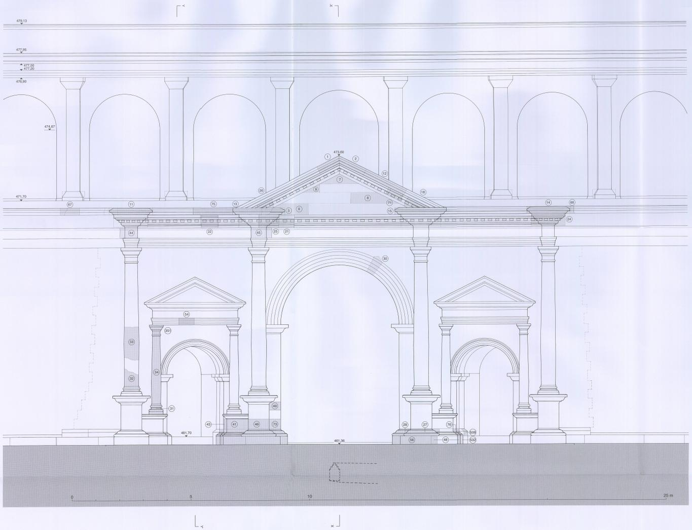
23. Vue de la façade du portail du Refour dans son état restitué avec les blocs localisés et la position des coupes AA' à GG'. Ech. 1:50.
