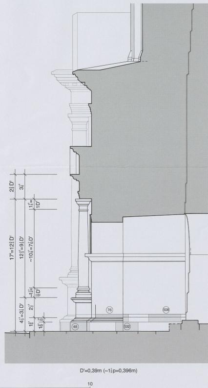
27.1. et 27.2. Les deux ordres du porcail avec les blocs localisés du passage nord; cotes en pieds et en diamètres D et D'. Ech. 1:50.
