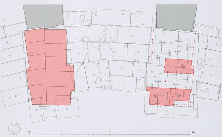
21.1. Plan de pose de l'assise 1 des piles F et F' sur le dallage. Ech. 1:50.
