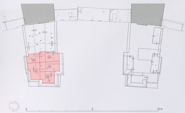
21.3. Plan de pose de l'assise 3 des piles F et F' sur l'assise 2. Ech. 1:50.
