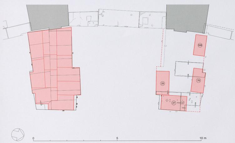
21.2. Plan de pose de l'assise 2 des piles F et F' sur l'assise 1. Ech. 1:50.
