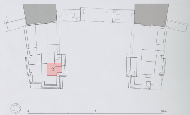
21.5. Plan de pose de l'assise 5 des piles F et F' sur l'assise 4. Ech. 1:50.
