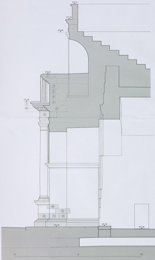
25. Coupe et vue au sud par le passage axial avec les blocs localisés. Ech. 1:50.
