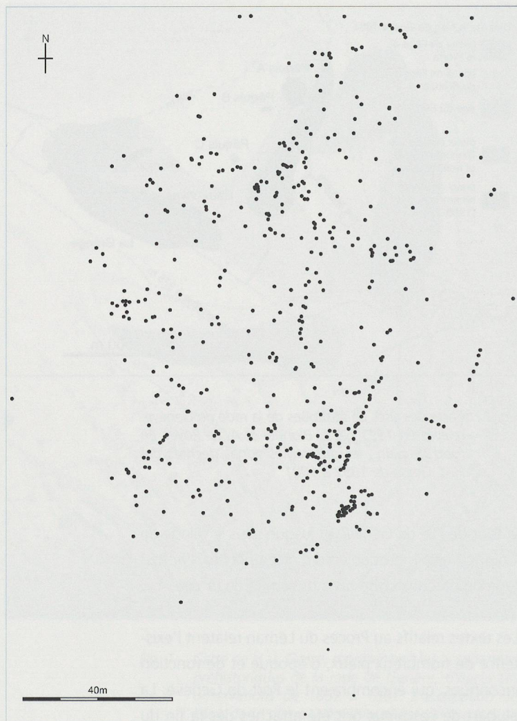
Fig. 3 Plan des pilotis de la station des Pâquis A, d'après le relevé de Louis Blondel réalisé en 1921. Les diamètres des pilotis n'ont pas été mesurés, tous les pieux sont donc représentés avec des points de même taille.
