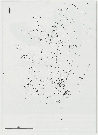
Fig. 3 Plan des pilotis de la station des Pâquis A, d'après le relevé de Louis Blondel réalisé en 1921. Les diamètres des pilotis n'ont pas été mesurés, tous les pieux sont donc représentés avec des points de même taille.
