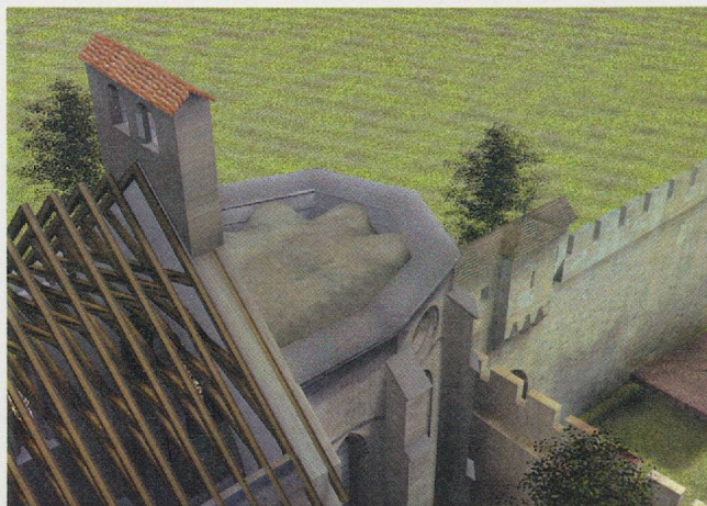
Fig. 21 Selon la règle, seul le chœur était voûté; un mur pignon supportait le beffroi au-dessus de l'arc triomphal. (Archéotech SA)
