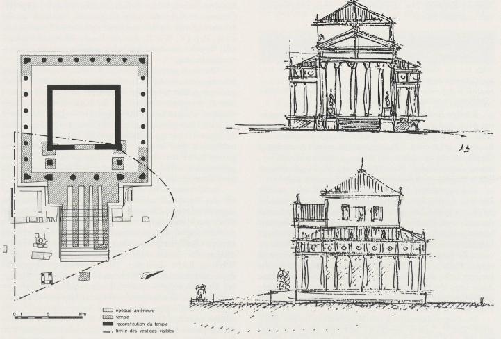
Abb. 7 Avenches, Vierecktempel von La Grange-des-Dîmes. Ergänzter Grundrissplan. Nach H. Bögli (1991). M. 1:400.
