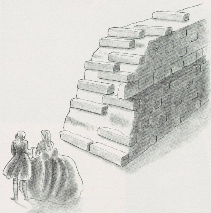
Fig. 34. Restitution du système constructif du premier mur VI<sup>1</sup> de la terrasse est.
