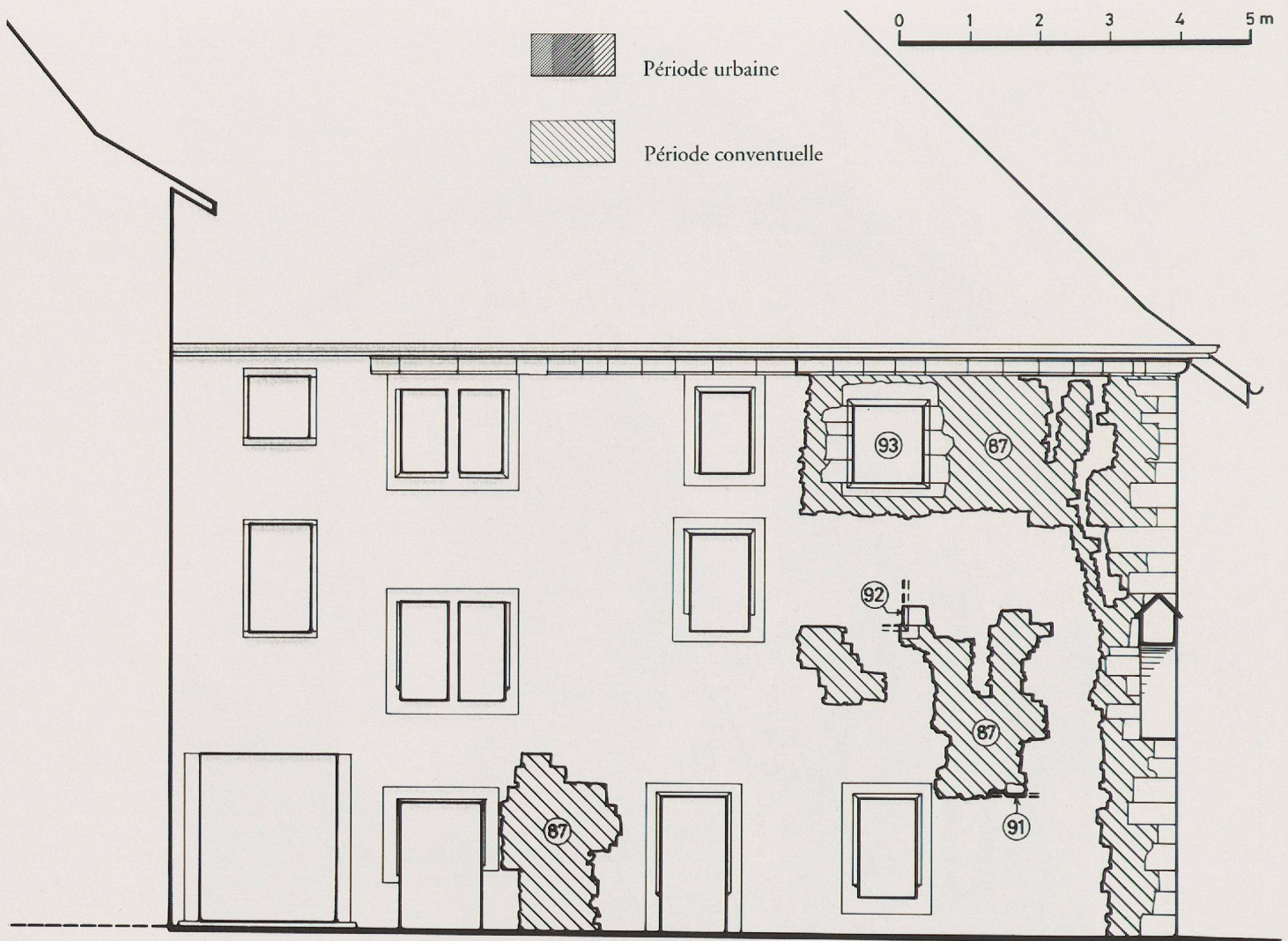
Fig. 65. Le «Vieux Couvent», structures préconventuelles et conventuelles sur le mur de façade nord. Ech.: 1:100.
