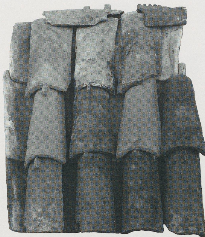
Fig. 6. Chéserex, église Notre-Dame de Bonmont. Tentative d'assemblage sur gabarit des différents types de tuiles canal.
