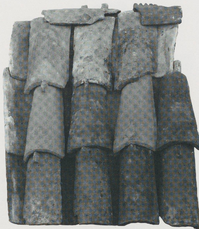
Fig. 6. Chésereux, église Notre-Dame de Bonmont. Tentative d'assemblage sur gabarit des différents types de tuiles canal.
