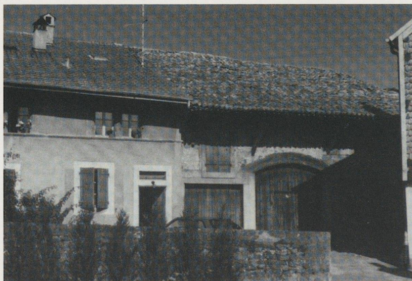
Fig. 154. Gilly, rural portant la date de 1643 sur la porte de grange. Toiture peu inclinée couverte de tuiles canal sans crochet posées sur sortes de chevrons de section triangulaire.
