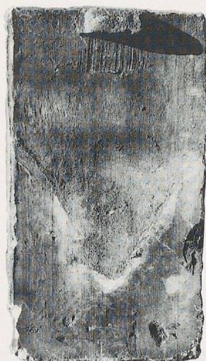
Fig. 13a-b. Talon typique de la technique «à la française», formé au moyen d'une languette de terre rabattue sur la surface intérieure (a. Lutry, église). La partie inférieure du talon devant s'appuyer sur la latte est coupée à angle droit afin de garantir une meilleure stabilité (b. Aubonne, église Saint-Etienne).
