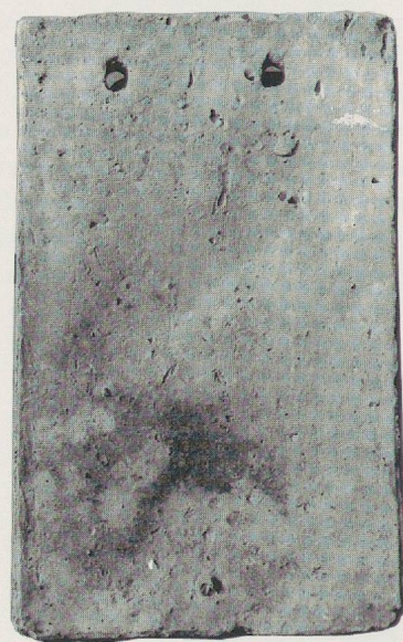
Fig. 118. Tuile à découpe droite pourvue de deux trous ronds en lieu et place du talon (Chésèrex, église Notre-Dame de Bonmont).
