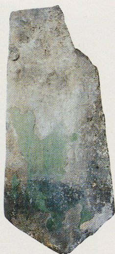
Fig. 69. Tuile de clocher, provenant de la Tour de Vaud ou de la tour d'escalier du château de Nyon, décorée d'une glaçure verte sur engobe.
