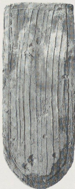
Fig. 41. Le tracé des cannelures, le plus souvent parallèles, est très simple. Une strie vient souvent souligner le pourtour de la tuile. XV e -XVI e siècle (?) (Avenches, Tour de Montauban).
