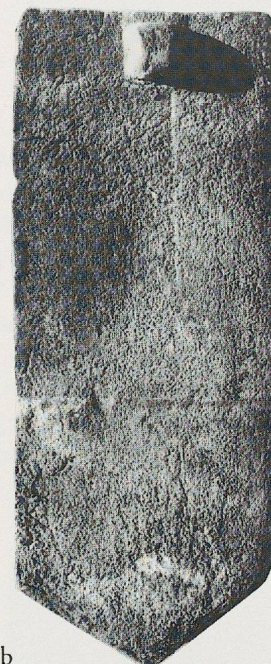
Fig. 38a-b. Tuile à surface extérieure lissée, provenant de la Tour Barraud à Payerne, et probablement antérieure au XVII e siècle. Les grandes dimensions sont typiques des tuiles façonnées «à l'allemande», alors que l'aspect de la surface intérieure, éventuellement moulée, fait penser à l'autre technique de fabrication.
