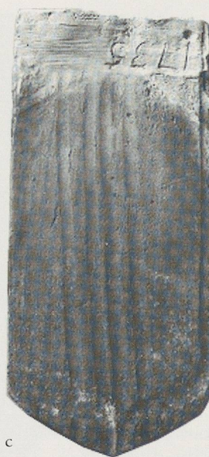
Fig. 54 a-c. Parallèlement à l'introduction de la bande de stries au sommet de la tuile, le tracé des gouttières verticales devient plus varié, deux d'entre elles se terminant en accolade dans la pointe (a. Agiez, cure; b. Lutry, église; c. provenance inconnue (1735).
