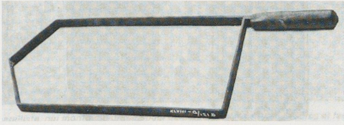
Fig. 23. Moule à tuiles «à l'allemande» en fer, matériel attesté pour la confection de moules dès le début du XVII e siècle en tout cas (Lausanne, Musée historique).
