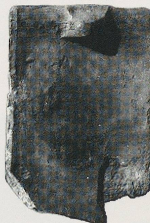
Fig. 131a-c. Les talons des tuiles «à l'allemande» les plus anciennes sont de forme trapézoïdale et soigneusement façonnés. Ils sont associés indifféremment à des modèles à découpes droite (a), ogivale (b) et pointue (c) (a. Payerne, église paroissiale; b. Vufflens-le-Château, château; c. Yverdon, château. Aile nord).
