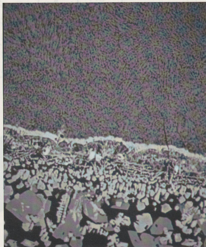
Fig. 152. Bordure d'oxydes de fer complexe à la surface des cordons de scorie. Ech. MON 67. Image en électrons rétrodiffusés (BSE).
