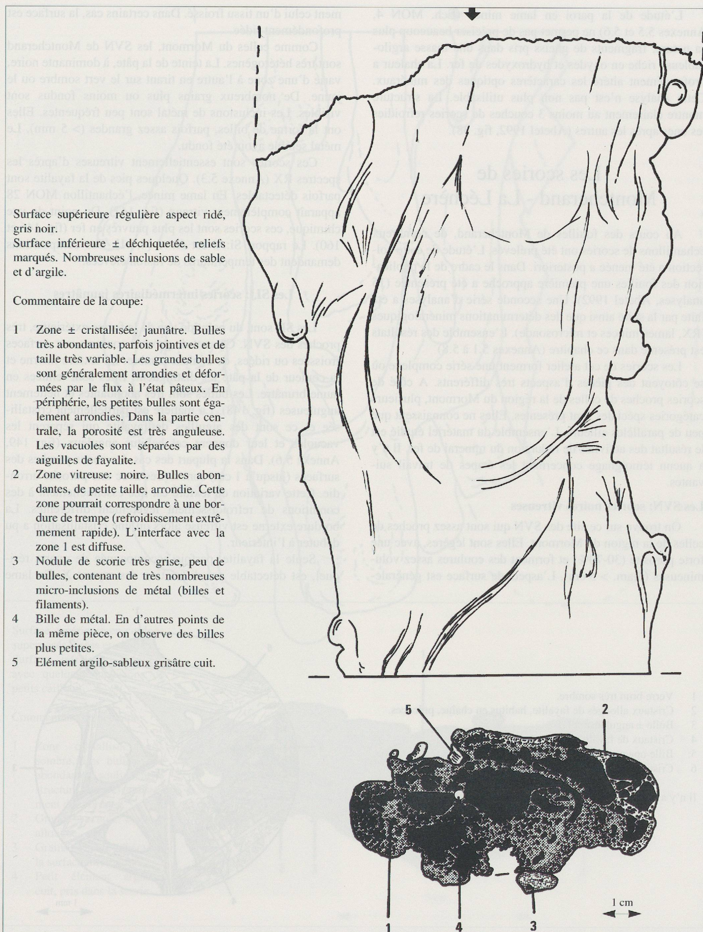
Fig. 148. SIJ: scorie intermédiaire jaune, en forme de tuyau. Ech. MON 81 (Montcherand): vue de dessus et coupe.
