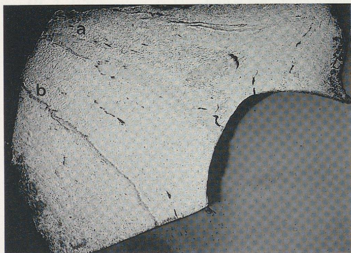
Fig. 165-166. Bellaires I. Examen métallographique d'un tranchant de pioche.
