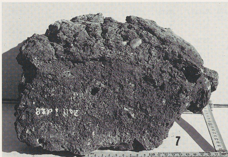
Fig. 152. Bellaïres I. Scories massives: 7, fond du four V; 8, paroi du four XI.
