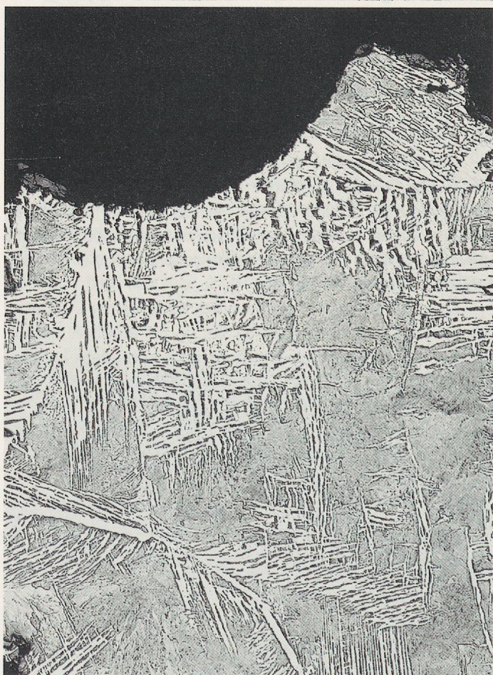
Fig. 155-156. Bellaires I. L'examen métallographique de déchets métalliques non travaillés.
