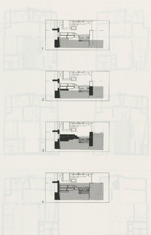
Fig. 27. Cour haute, façade est: évolution du niveau de circulation (éch. 1:150).
