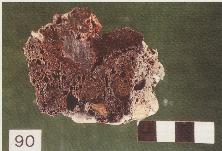
Fig. 39a à c Nodules de fer formés à proximité des éponges et provenant des bas-fourneaux V - échantillons n° 27, 35 et 90 (Photos IAHA).
