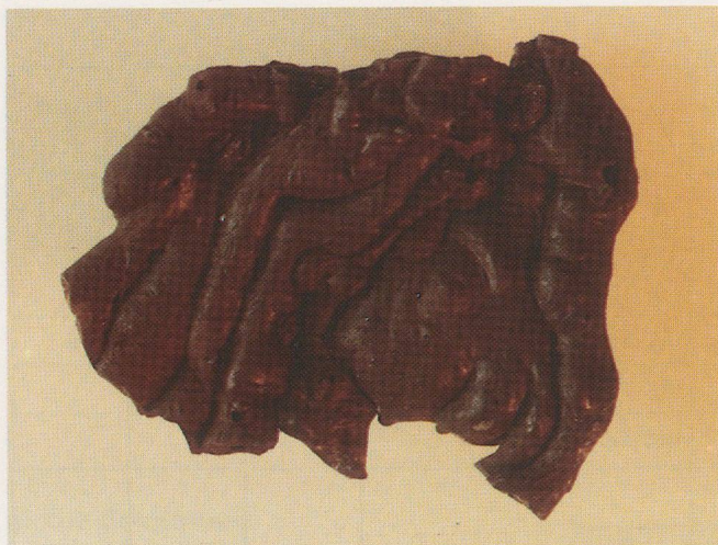
Fig. 33 Scorie vitreuse provenant du ▶ bas-fourneau I - échantillon n° 5 (Photo IAHA).
