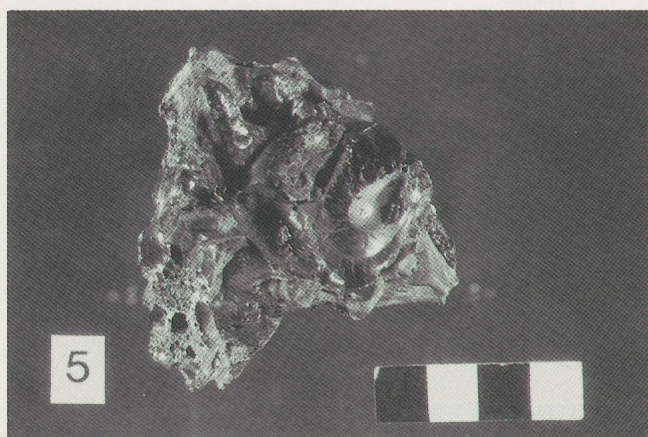
◀ Fig. 34 Scorie vitreuse provenant du bas-fourneau IIb - échantillon n° 13 (Photo IAHA).
