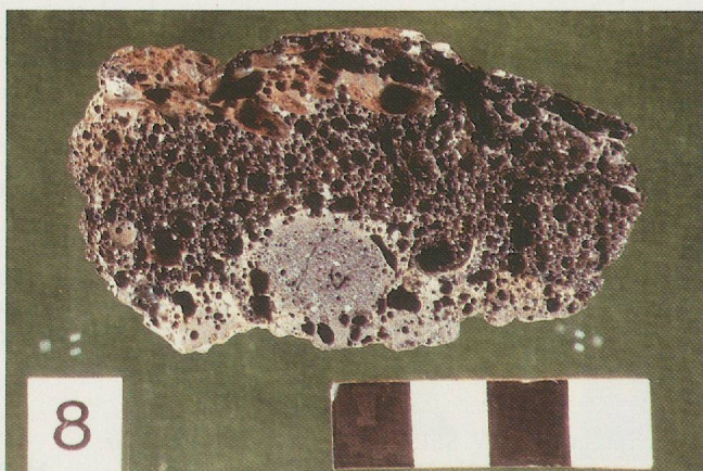
Fig. 35 Scorie légère provenant du ▶ bas-fourneau V - échantillon n° 8 (Photo IAHA).
