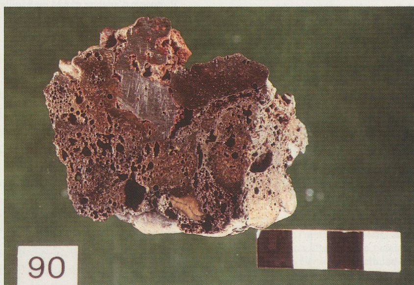
Fig. 39a à c Nodules de fer formés à proximité des éponges et provenant des bas-fourneaux V - échantillons n° 27, 35 et 90 (Photos IAHA).
