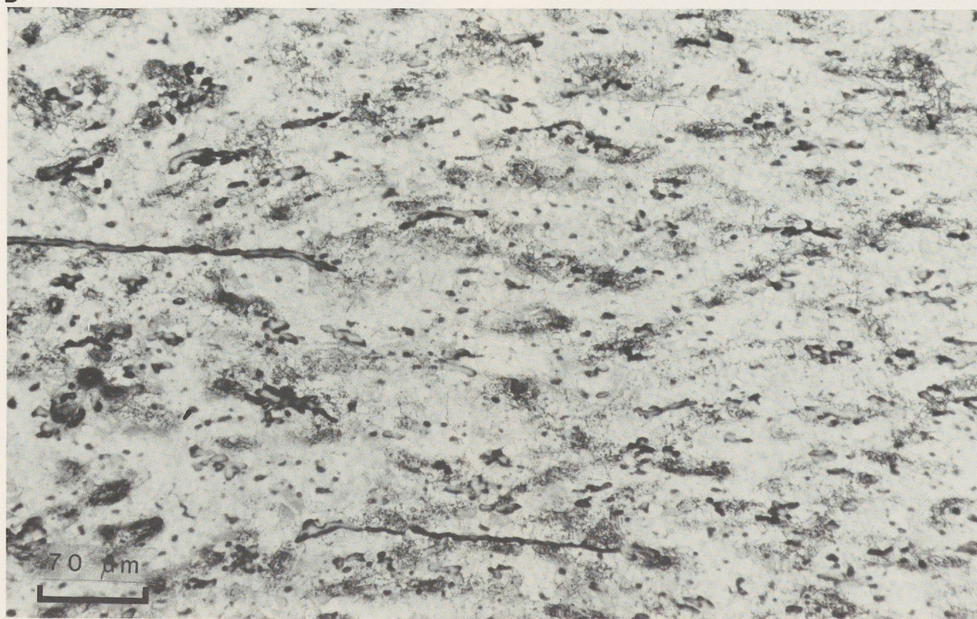
Fig. 12 Faucille 23/2. Coupe transversale de la lame au voisinage de la cassure.
