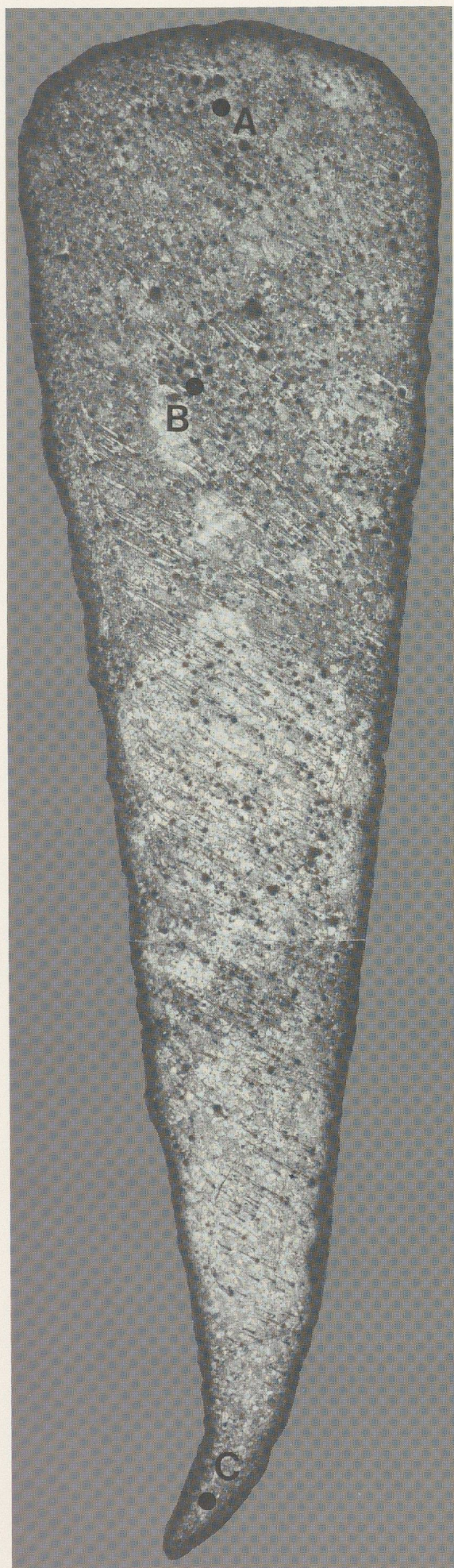
Fig. 7 Couteau 19/5. Coupe transversale totale et détails. 1 = liseré. 2 = phase \delta . 3 = traces du polissage de l'échantillon.
