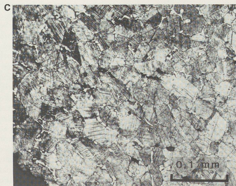
Fig. 7 Couteau 19/5. Coupe transversale totale et détails. 1 = liseré. 2 = phase \delta . 3 = traces du polissage de l'échantillon.
