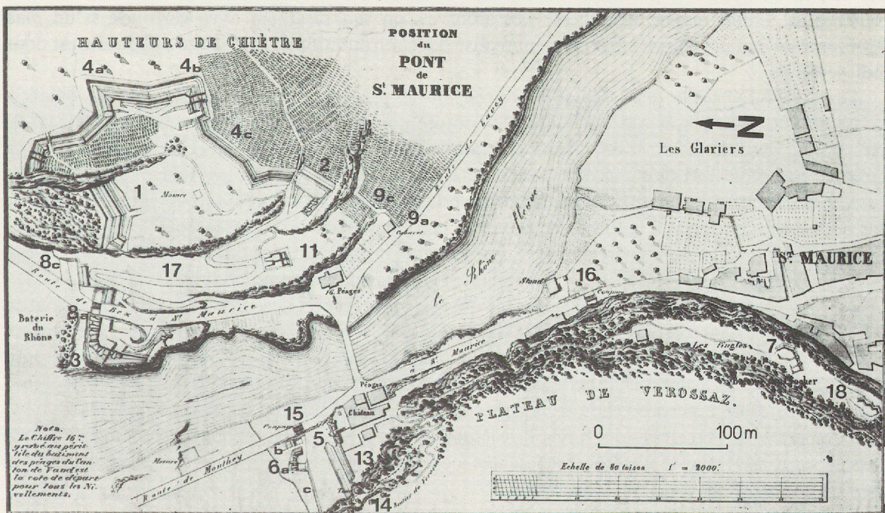
Fig. 45 La position de Saint-Maurice après les travaux de 1848. Détail du plan Dürr (1851). Numérotation des ouvrages: voir tableau synoptique, pp. 130-131.
