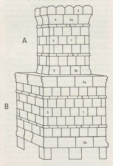
Fig. 2. Structure du poêle.
