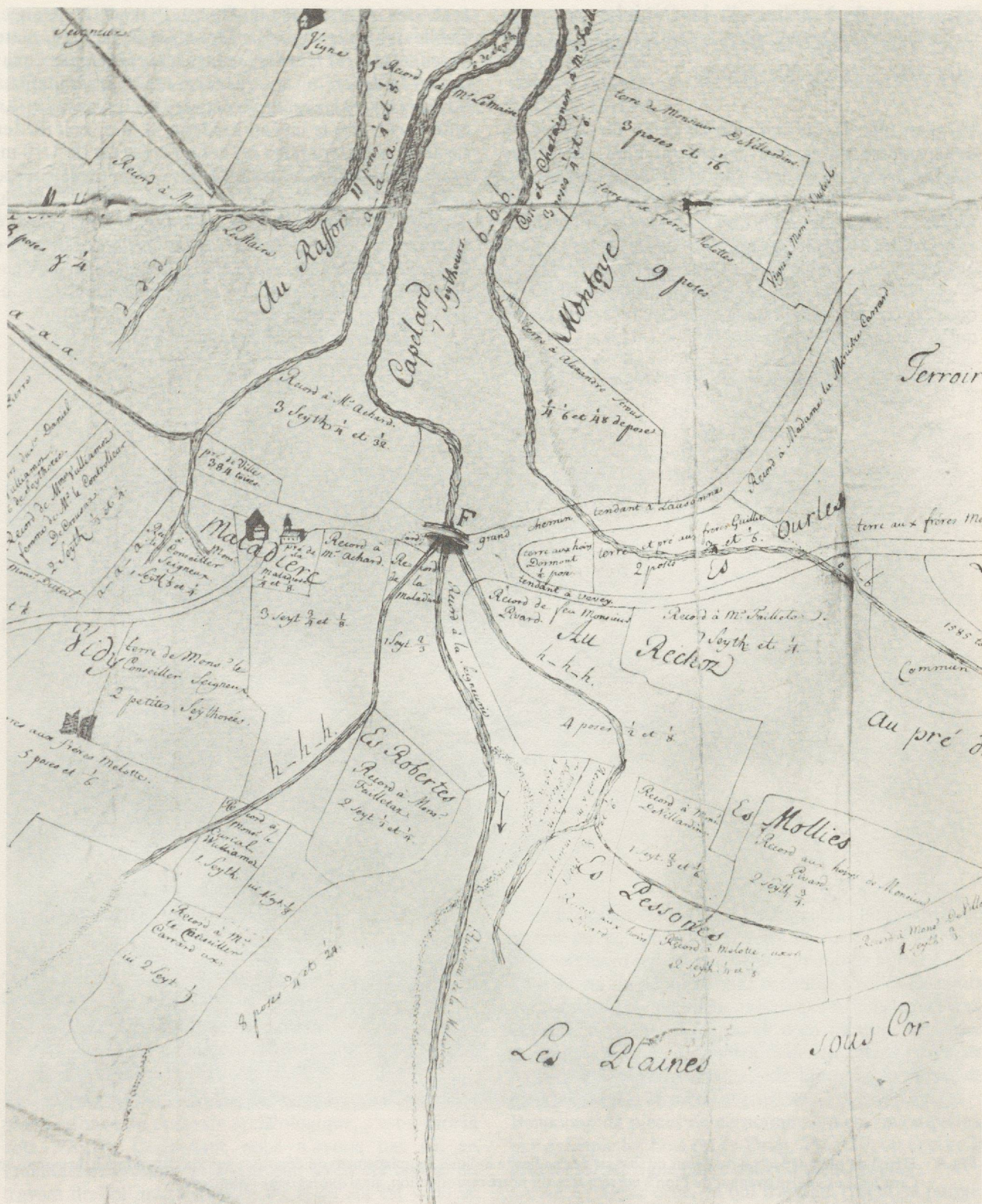
Fig. 3 Détail d'un plan daté de 1724 dont voici le titre: « Plan du cours du Flon, avec les écluses qui servent à arroser les prés de Vidy et autres. » (ACV: GC 132/G1). L'Ecluse F: « Ecluse sous le pont de la Maladière, construite par la Seigneurie de Lausanne, pour égayer les plaines deçà et delà ce flon, pour environ 90 poses, et qui par ses canaux à double, h-h-h, elle arrose aussi les prés des particuliers,... ».
