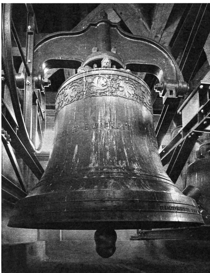
Abb. 7: Eriswil BE, Glocke c' mit neuem Klöppel von 2016, entworfen von Firma mit Expertenberatung. – Foto: Matthias Walter.
